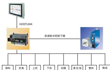
图1 控制系统框架
